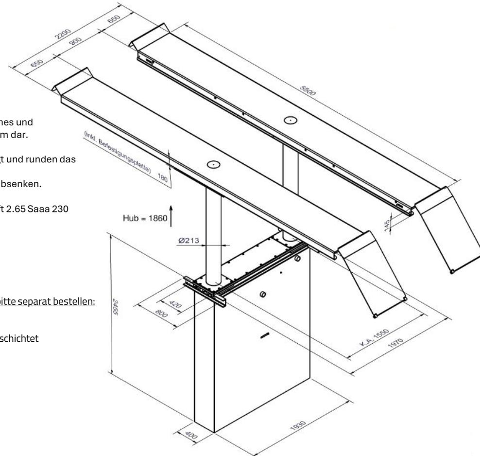
Die **Biglift 2.65 F550** ist eine Fahrbahnhebebühne mit enormen **6,5 Tonnen** Tragfähigkeit. Einfaches und unkompliziertes Anheben von **Nutzfahrzeugen aller Art** stellt mit dieser Hebebühne kein Problem dar.
